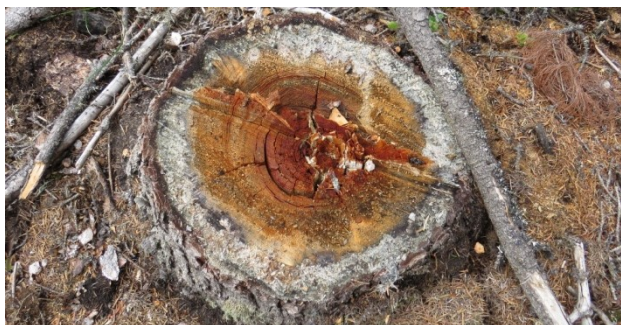
Ель на Камчатке непригодна для строительства, ее стволы гнилые внутри. Spruce in Kamchatka is bad construction material, its stems often are rotten inside.
